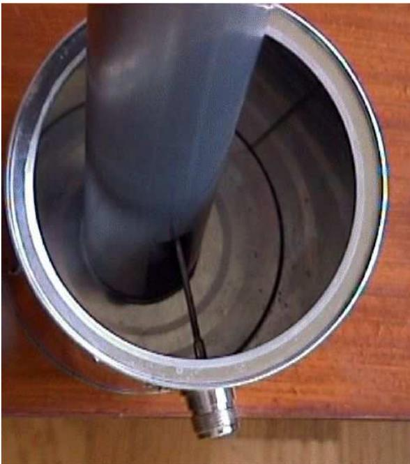
Remarqué le centreur coller au fond de la boîte, c'est de la recup d'un cache en plastique conique qui assure le centrage du PVC, faire un trou dedans permet de le mettre en place avec un tournevis par exemple
