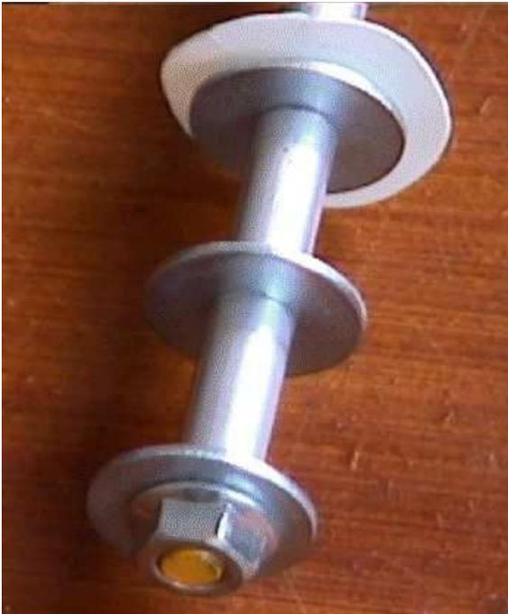
détail du bout l'écrou est en acier classique, les rondelles blanches sont la pour calé le tous dans le tube pvc, vous les découpez dans n'importe quoi en plastique un peut flexible ( celle-ci sont faites dans un couvercle de pot de nutella ) le diamètre est = au dia. Int. Du tube PVC.
